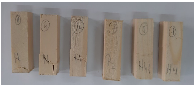
Foto 18. Rezistența la compresiune paralelă - ruperi caracteristice.
