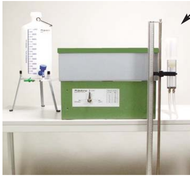
Fig. 3.2. Aparatul pentru determinarea sucțiunii prin metoda cutiei cu nisip, Ejkelkamp Agrisearch Equipment
