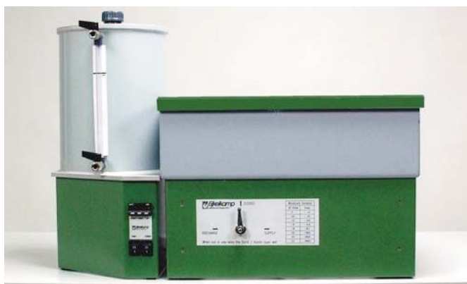
Fig. 3.5. Aparatul pentru determinarea suțțiunii prin metoda cutiei cu nisip și caolin, Ejkelpamp Agrisearch Equipment
