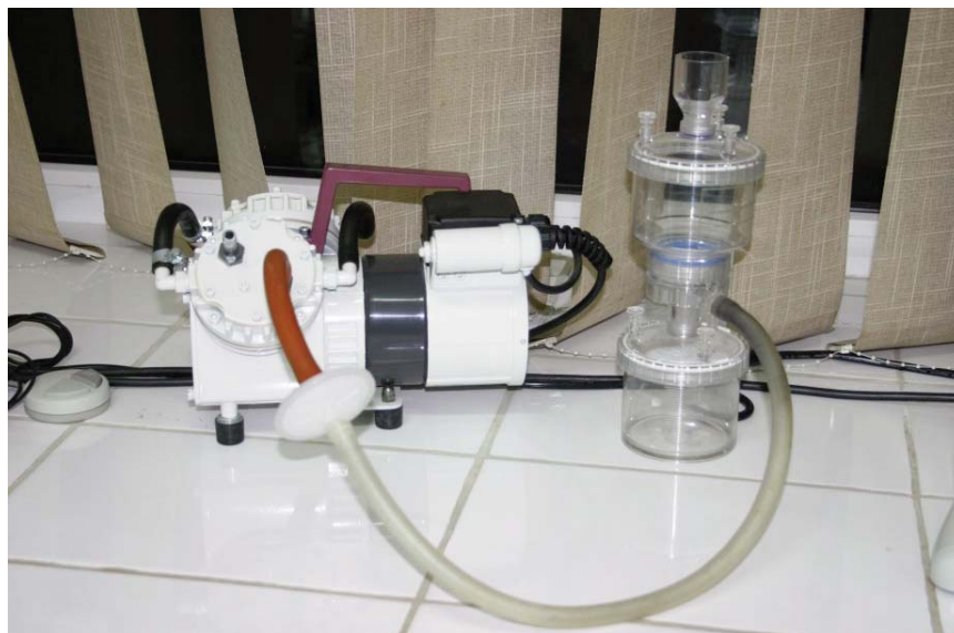
Fig.5.1. Sistem de filtrare Sartorius conectat la pompa de vid
