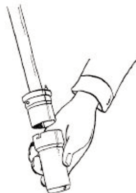
Fig. 2.10. Fixarea cilindrului de recoltare
