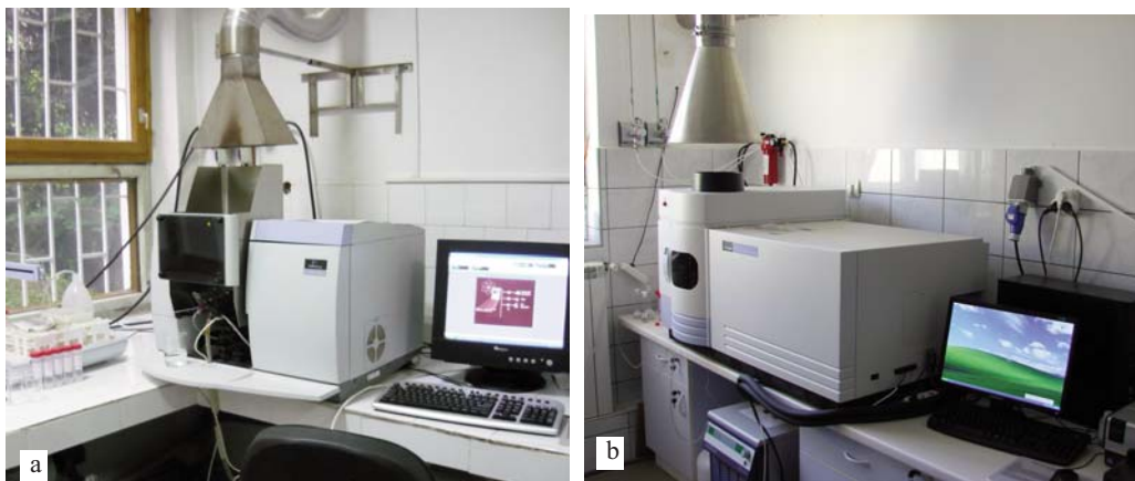
Fig. 3.22. Spectrometru cu absorbție atomică (AAS 400), Perkin Elmer (a) și spectrometru inductiv cuplat cu plasmă optică (ICP OES), Perkin Elmer (b)
