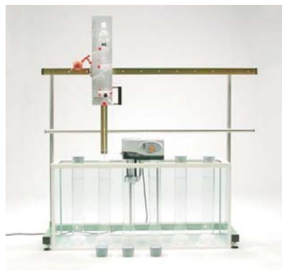
Fig. 3.10. Aparatul cu pipetă pentru determinarea fracțiilor granulometrice, Ejkelkamp Agrisearch Equipment
