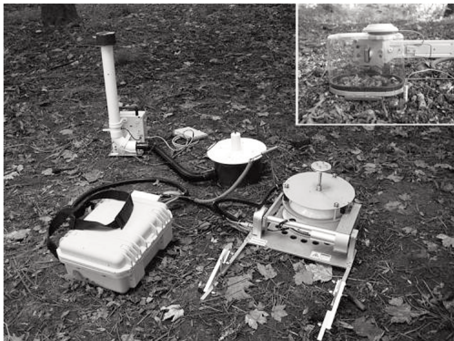
Fig. 3.19. Cameră deschisă pentru măsurarea respirației solului
