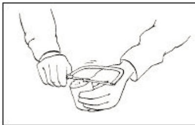
KIT DE SOL CU SUPPORT ÎNCHIS DE CILINDRI Fig. 2.5. Îndepărtarea surplusului de sol
