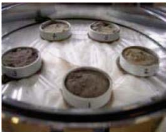
Fig. 3.9. Amplasarea probelor de sol în aparat pe placa de bază
