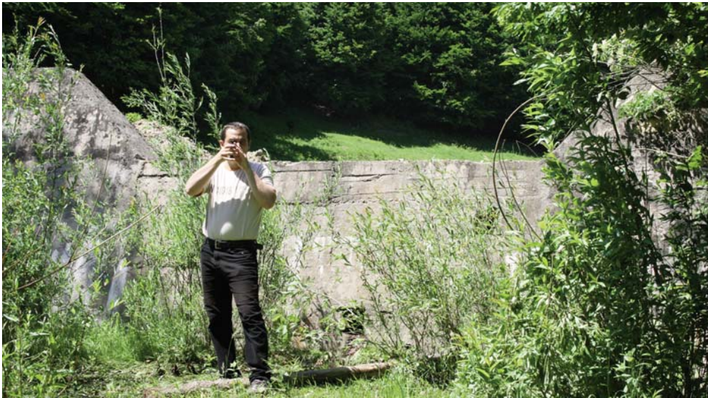
Fig. 5. 14. Măsurarea pantei de aterisare cu ajutorul dendrometrului românesc cu pendul (Foto: Loriană 2009). Measuring the siltation slope using the Romanian dendrometer with pendulum (photo: Loriană 2009)
