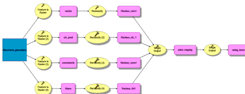
Fig. 4. 3 Modelul realizat cu ajutorul aplicației „Model Builder” specifică programului ArcMap. (Tamaș, Clinciu 2006). Model - created with „Model Builder” (ArcMap software)
