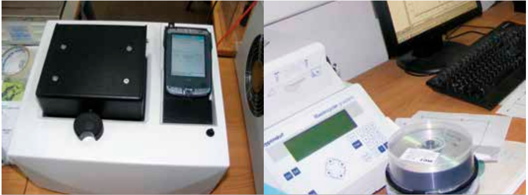
Fig. 15. Mașinile termocycler utilizate în analizele genetice PCR machines used for genetic analyses
