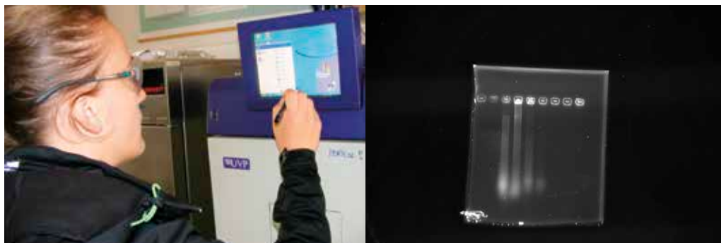
Fig. 12. Aparatul UVP pentru analiza gelului (stânga) și fotografia gelului (dreapta) UVP device for gel analysis (left) and the gel picture (right)
