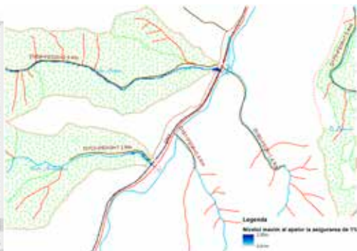
Fig. 5.42. Planurile de situație cu zonele de inundabilitate pentru Q1% (Tudose et al., 2020).
