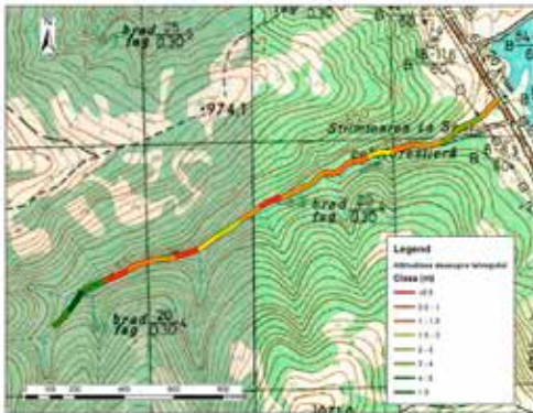
Fig. 5.5. Delimitarea sectoarelor drumului forestier Valea Adâncă de Jos pe clase în funcție de diferența de nivel între cota talvegului și cota drumului.
