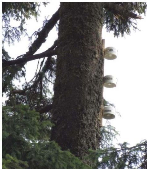
Fig. 2.3.4 Amplasarea dispozitivelor și filtrelor pasive de ozon în coroana arborilor
