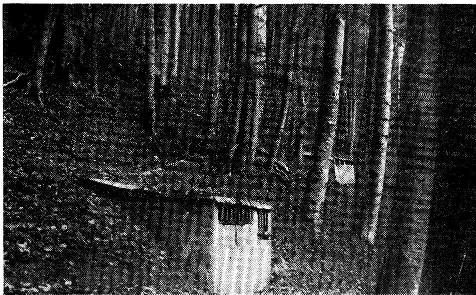
Fig. 7 — Bazine de beton pentru colectarea apei scursă din parcelele instalate în arboretul de fag
