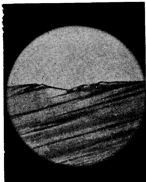
Fig. 7 — Uzura muchiei cuțitului de oțel rapid după frezarea a 510 ml de P.A.L. ( \times 24 )
