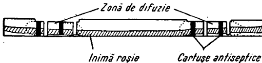
Fig. 1 — Zonele de difuzie ale fungicizilor din cartușele antiseptice
